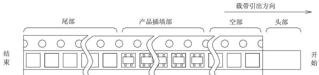
(1) - 1. 素子印刷面在盖带侧，胶带引出方向与素子的长边侧保持一致后再封装。素子方向（180° 旋转）无规定。
